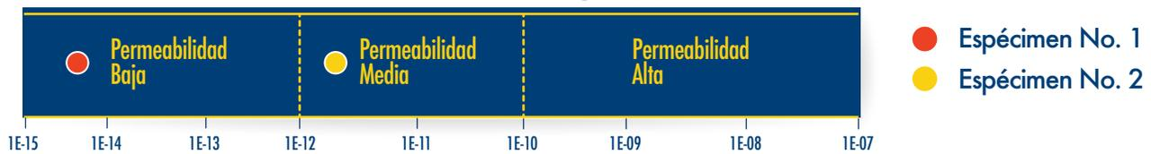
Donde: Especimen 1 corresponde a concreto Ultra-impermeabilizado. / Especimen 2 corresponde a concreto Estándar.
